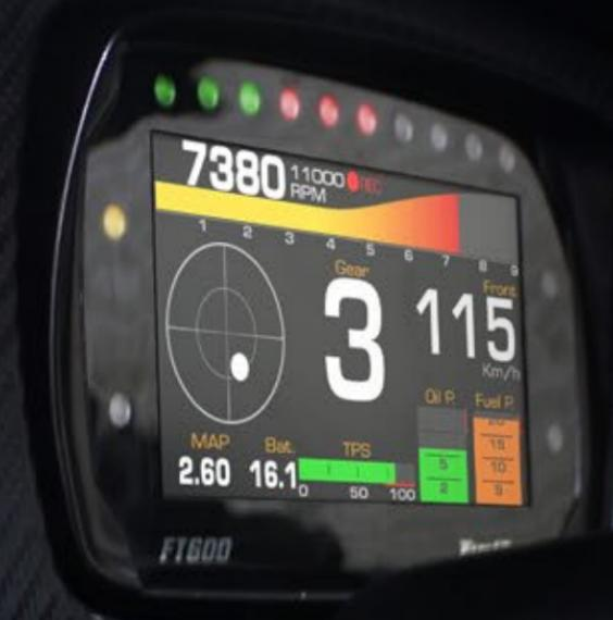
Gabinete em alumínio à prova d'água (IP67)
