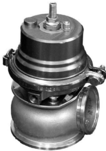
Ejemplo de una válvula wastegate instalada en el colector del escape
