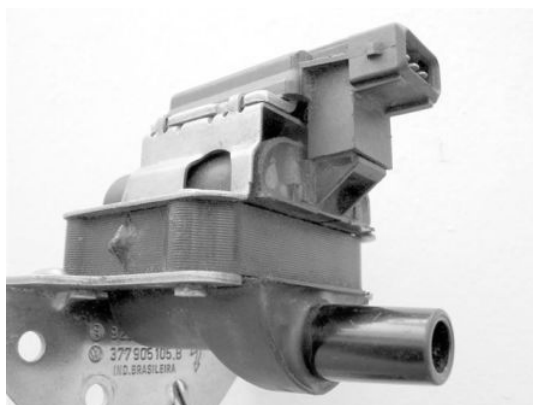
Bobina Bosch F 000 ZS0 104 (original del VW Gol 1.0 8V) con módulo de ignición integrado.
