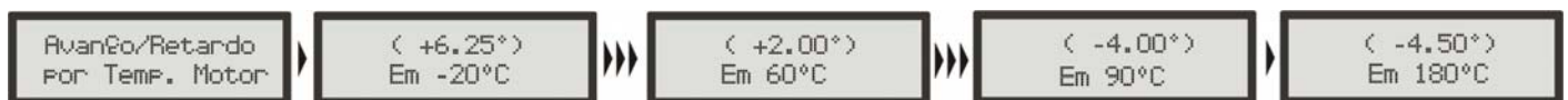
Mapa de corrección de Ignición por Temperatura del Motor, con 11 puntos, de -20°C hasta 180°C
